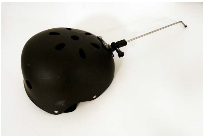
Fig. 4. Elemento frontal metálico implementado en un casco de bicicleta.
