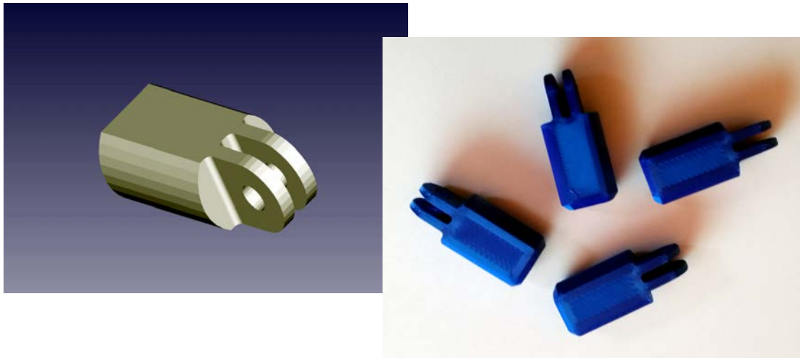
Figs. 5 y 6. Acople elaborado en impresión 3D
