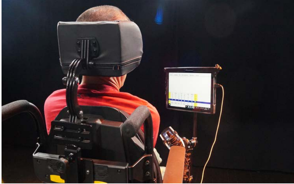
Fig. 5. Persona usuaria manejando un comunicador mediante un pulsador de este tipo conectado a su Tablet
