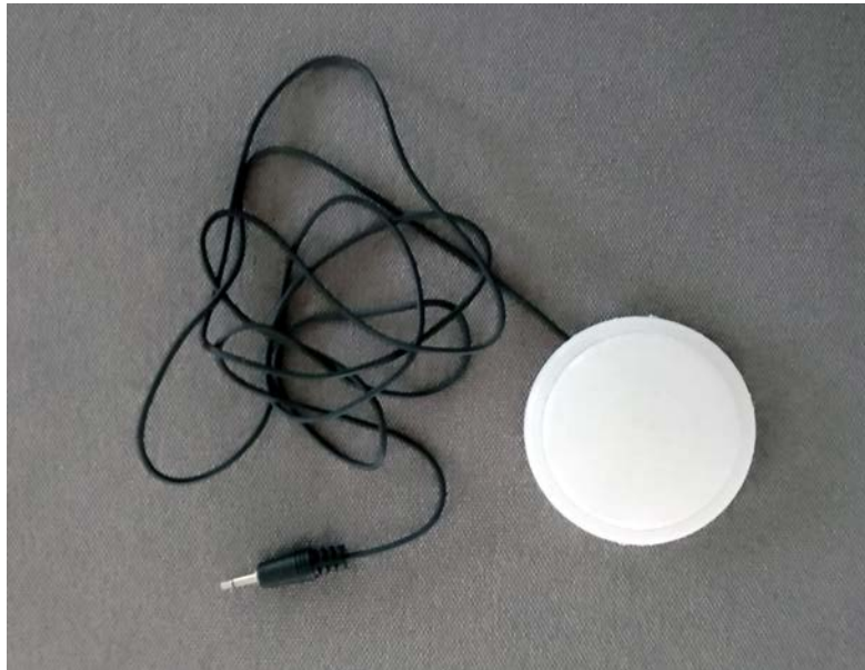
Fig. 6. Resultado final del pulsador plano de 80 mm listo para ser utilizado
