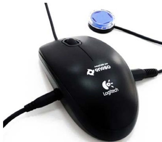
Fig. 1. Pulsador conectado a un ratón convencional que hace de interfaz
