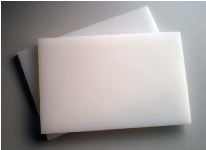
Fig. 3. Paneles de poliestireno ya cortados
