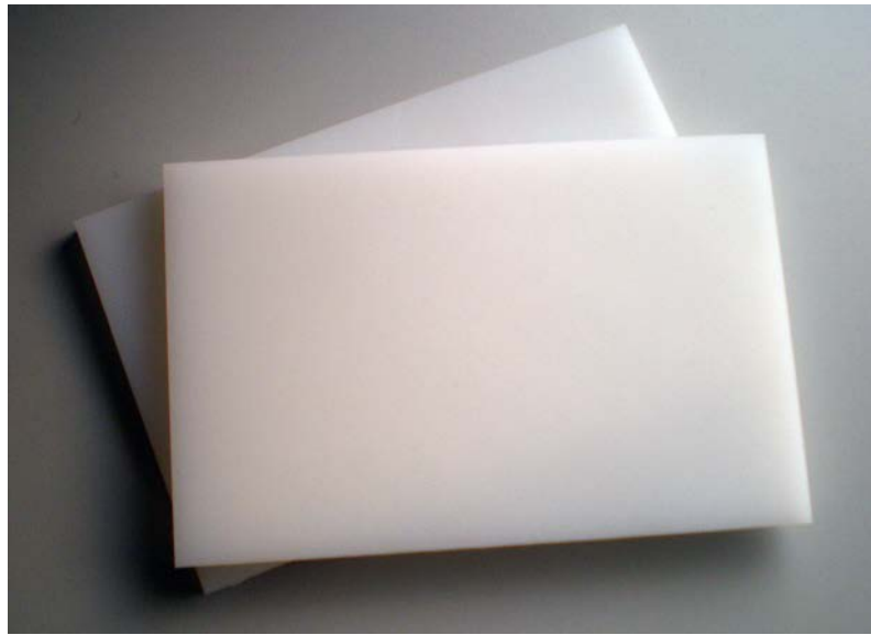
Fig. 3. Paneles de poliestireno ya cortados
